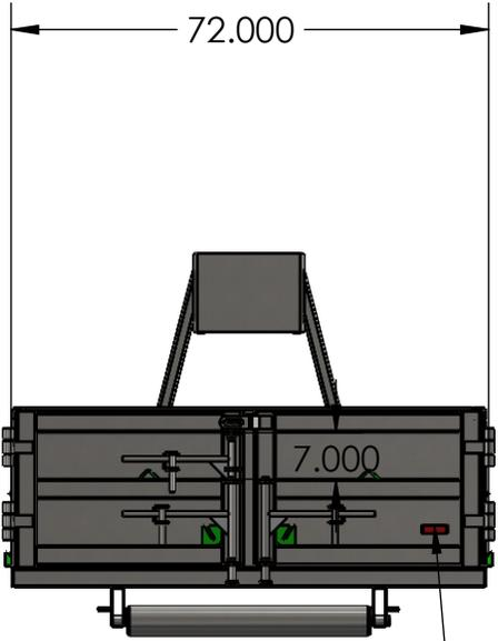
**Weld serial no. on Back door & Floor**
